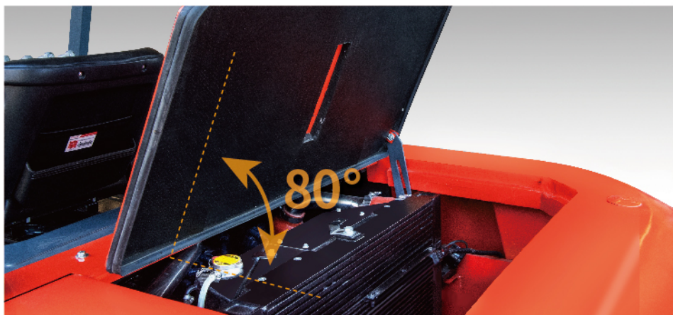
水箱支撑杆, 开启角度可达80°, 便于对散热器的检查
