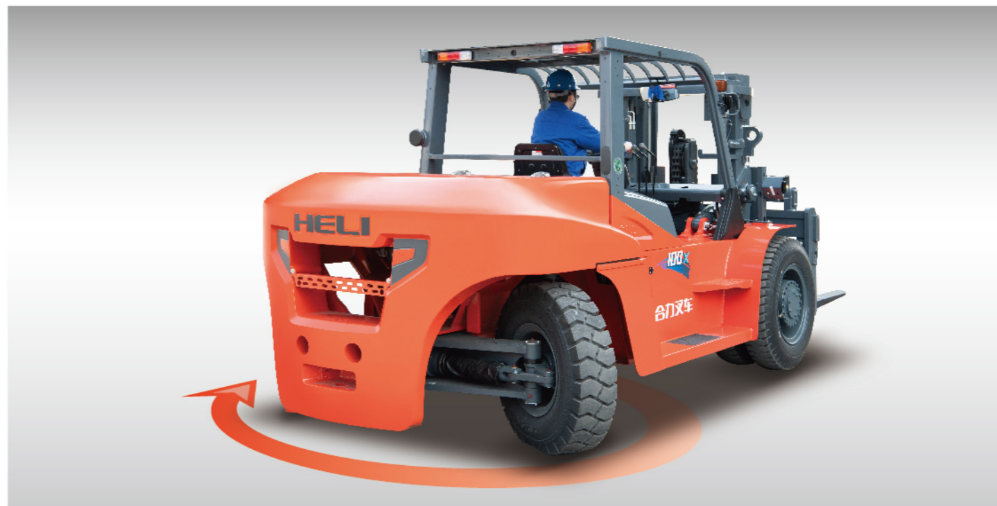
大转角转向桥，降低叉车转弯半径
