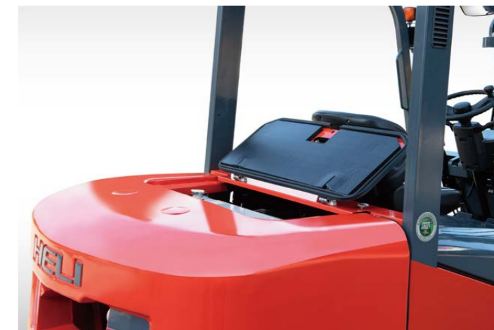
配重上盖开启角度大, 便于对散热器的检查
